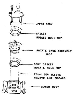
IF AN EPR VALVE IS PURCHASED FROM A REFRIGERATION WHOLE-SALER THE ILLUSTRATED MODIFICATION MUST BE MADE FOR PROPER VALVE OPERATION.
